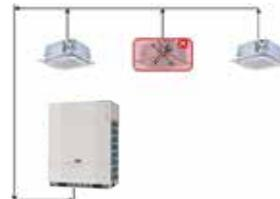
Im Außengerät gespeichertes Kältemittel
