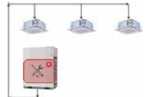
Im Innengerät gespeichertes Kältemittel
