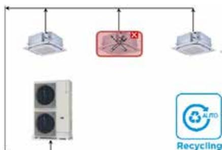
Im Außengerät gespeichertes Kältemittel
