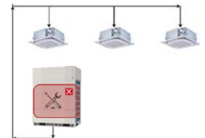
Im Innengerät gespeichertes Kältemittel
